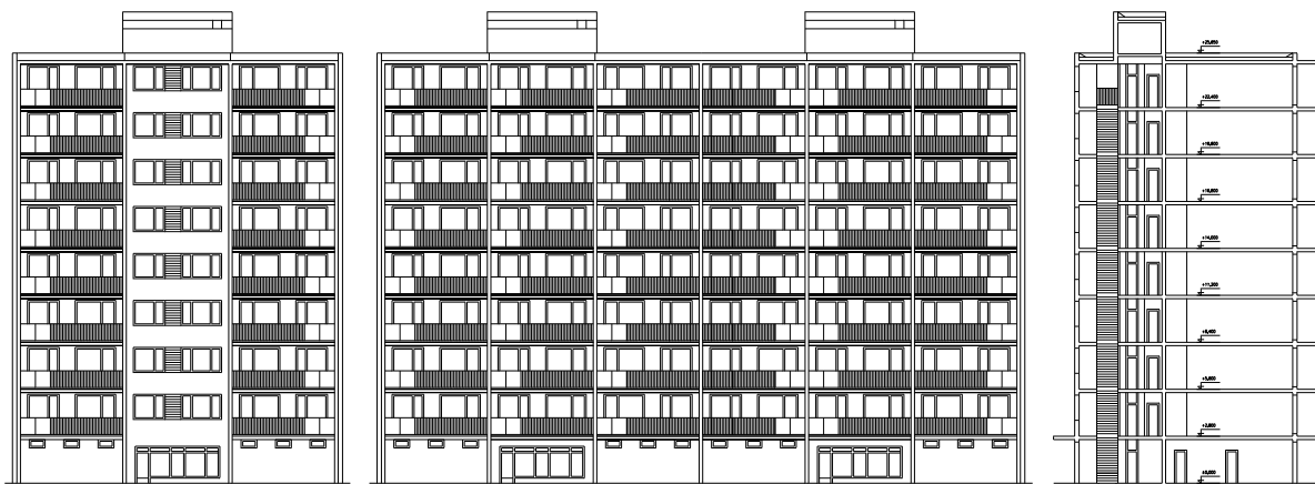
Obr. 4.10.2 Pohľad a rez 8 podlažným radovým domom T08B KE
