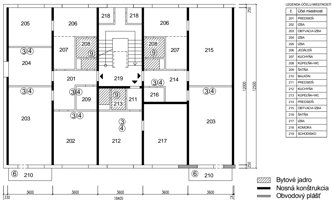
Obr. 4.9.10 Lokalizácia jednoduchých zásahov v radovom dome T06B NA (12 m)
