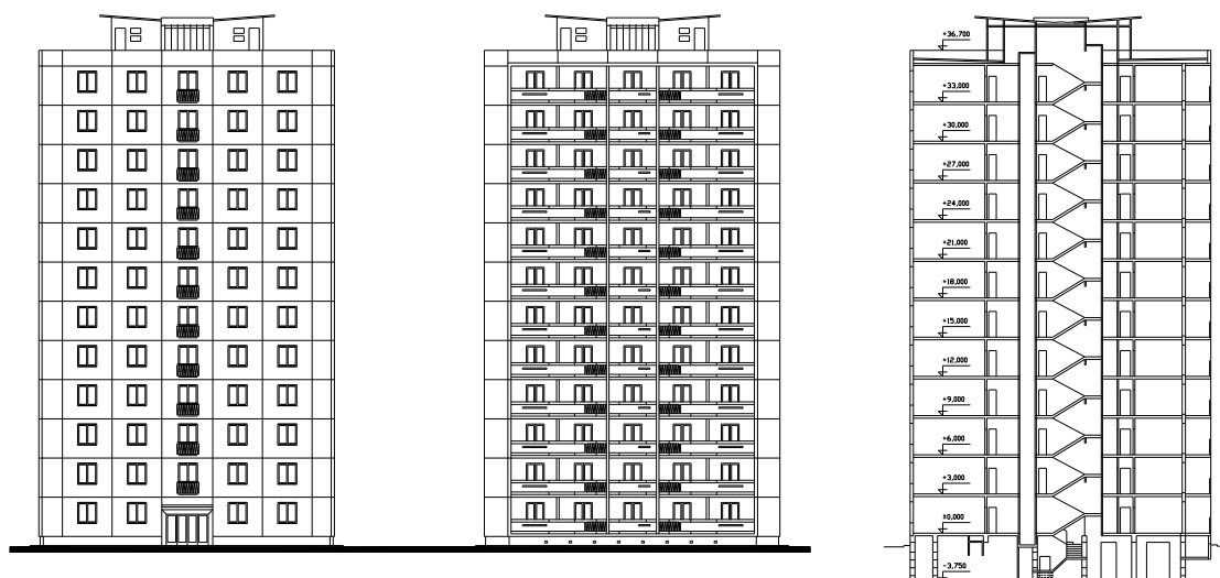
Obr. 4.1.4 Pohľady a rez vežovým domom BA
