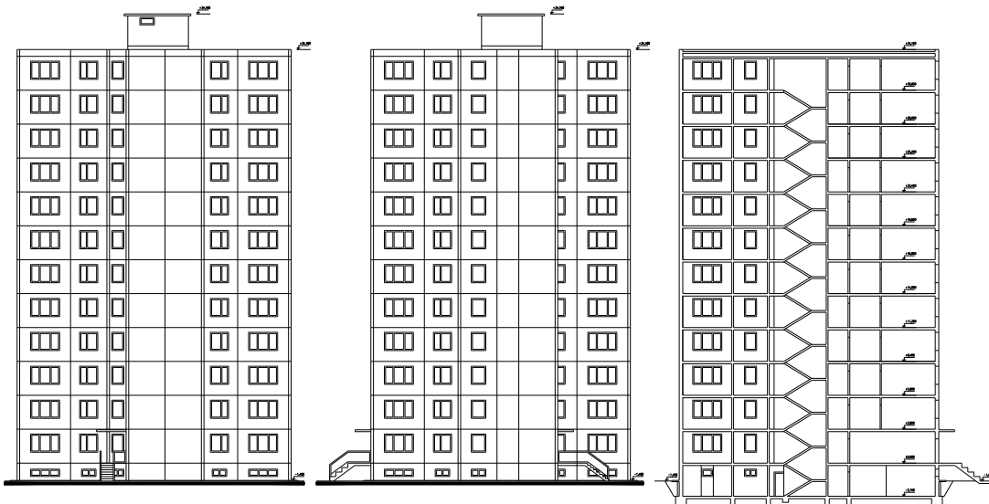
Obr. 4.15.4 Pohľad a rez bodovým domom BA NKS
