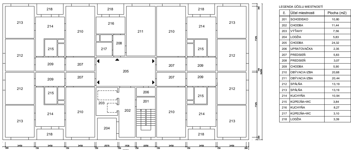
Obr. 4.19.8 Pôdorys typického podlažia vežového domu PS-82-PP
