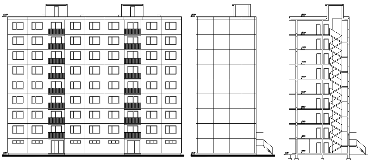
Obr. 4.19.4 Pohľad a rez radovým domom PS-82-PP
