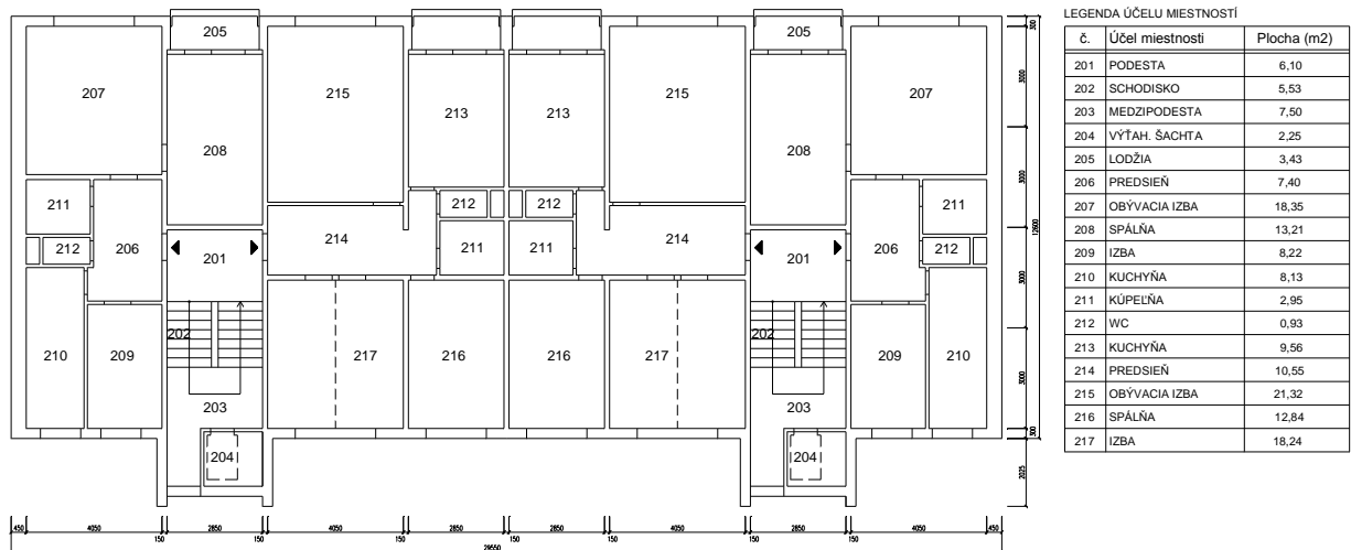
Obr. 4.18.5 Pôdorys typického podlažia radového domu P1.15
