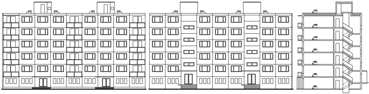
Obr. 4.7.3 Pohľad a rez radovým domom T06B BB
