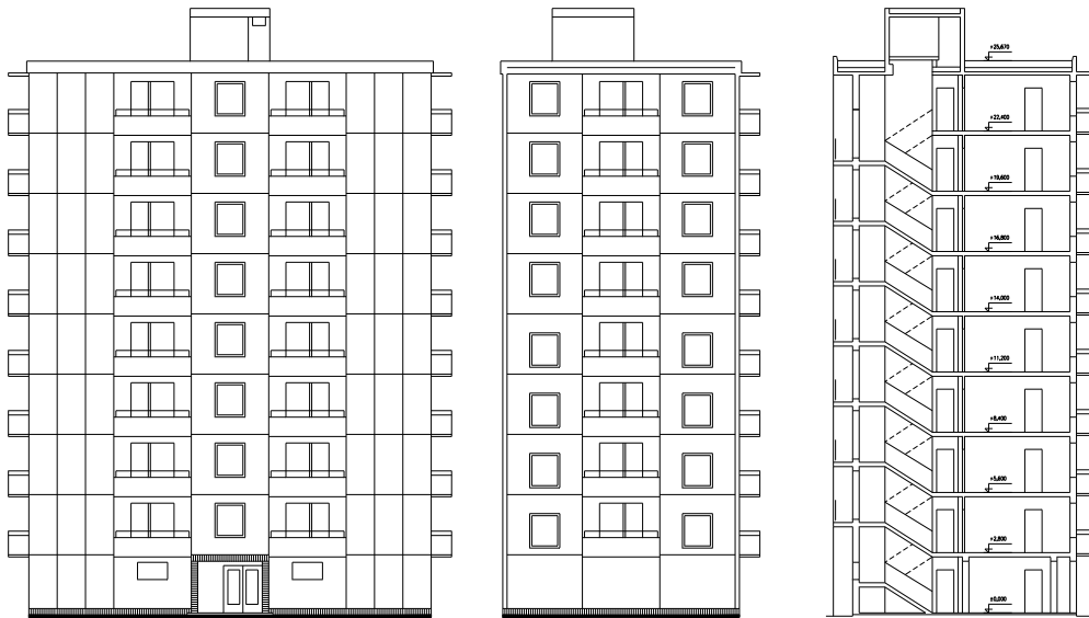
Obr. 4.7.4 Pohľady a rez bodovým domom T06B BB
