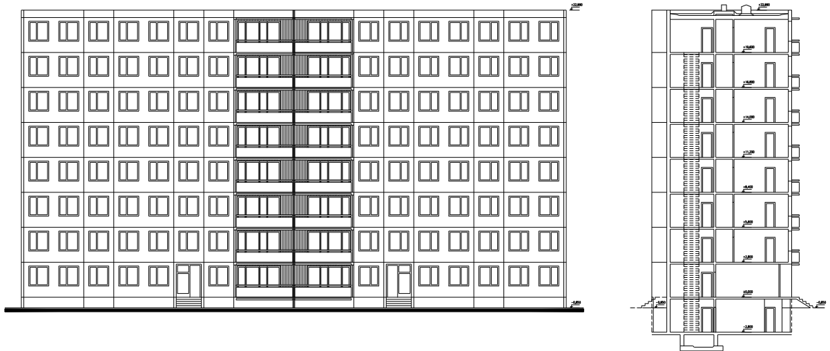
Obr. 4.14.3 Pohľad a rez radovým domom B-70
