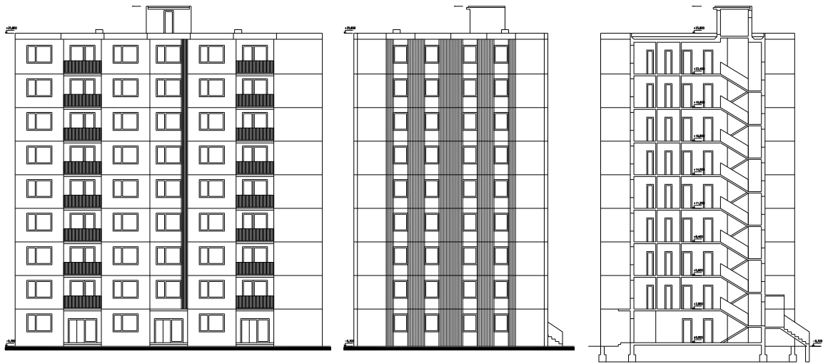
Obr. 4.19.6 Pohľad a rez bodovým domom PS-82-PP
