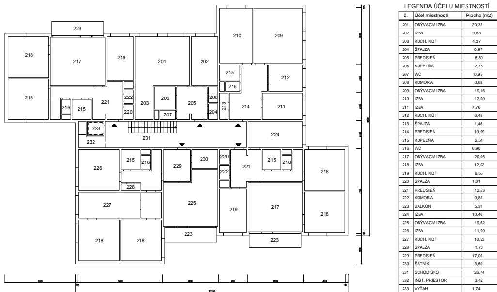
Obr. 4.14.6 Pôdorys typického podlažia bodového domu B-70
