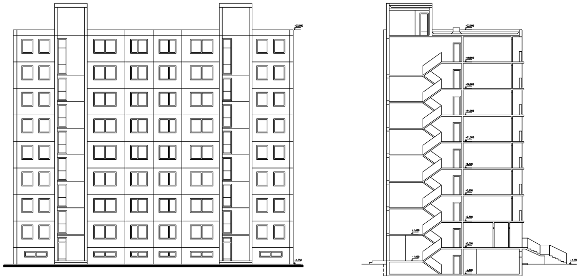
Obr. 4.18.3 Pohľad a rez radovým domom P1.15
